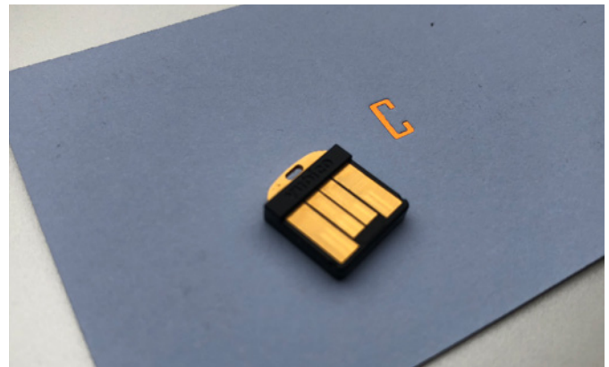
Abb. 2: Ein Yubikey – der Metallbügel am oberen Ende ist berührungsempfindlich
